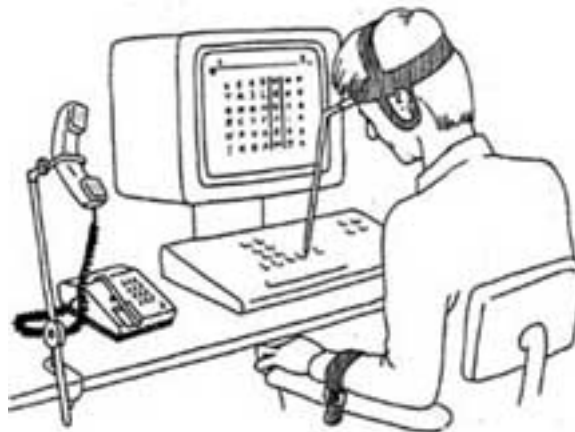
Εικόνα 5: Παράδειγμα βοηθήματος επικοινωνίας υψηλής τεχνολογίας με χρήση ηλεκτρονικού υπολογιστή.
