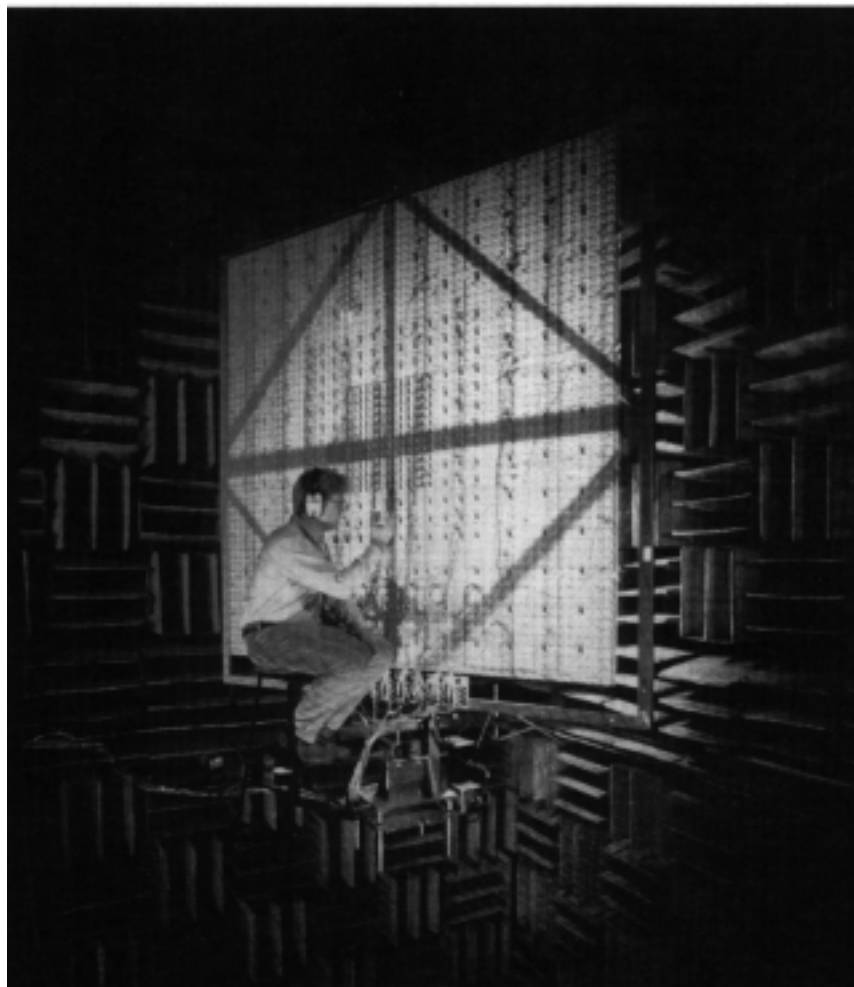
Σχήμα 8β: Μεγάλος δυσδιάστατος πίνακας αποτελούμενος από 408 μικρόφωνα ηλεκτρίτη. Κάθε μικρόφωνο έχει ένα chir αποκλειστικά δικό του για την μορφοποίηση ακτίνας.
